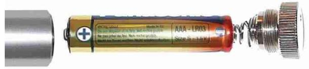
Batteriedeckel (8) hinten am Laser öffnen und einen Akku mit dem Pluspol voran in das Rohr stecken; den Batteriedeckel schließen und im Uhrzeigersinn ganz hineindrehendrehen.
