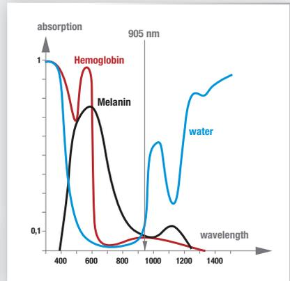
Die Laserstrahlung erfolgt in Form von kurzen Impulsen mit hoher Spitzenleistung. Dieser Emissionsmodus bewirkt, dass der Laserstrahl die **erforderliche Leistung hat, um das Gewebe zu durchdringen** und dabei gleichzeitig zu schonen, so dass die relevante Information ohne zerstörenden Thermoefekt an den Punkt gelangt.
