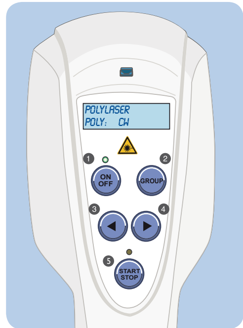
Bedienfeld auf der Oberseite des Polylaser
