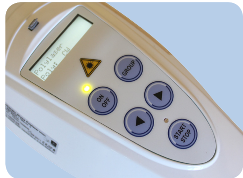
Bedienfeld auf der Oberseite des Poly laser
