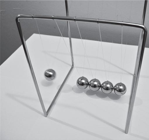
**Abb. 3.28** Kugelpendel. Hier wird nicht nur kinetische Energie in potenzielle Energie hin und her verwandelt, sondern auch durch still hängende Kugeln durchgeleitet. [2]
