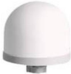
Der **Keramikvorfilter** lässt keinen Staub oder Rost und keine Schwebeteilchen durch. Die Keramik mit einer Porengröße von nur 0,2-0,5 µm ist so fein, dass kein Bakterium hindurchgelangt und somit ein effektiver Schutz vor Keimen aller Art gegeben ist.
