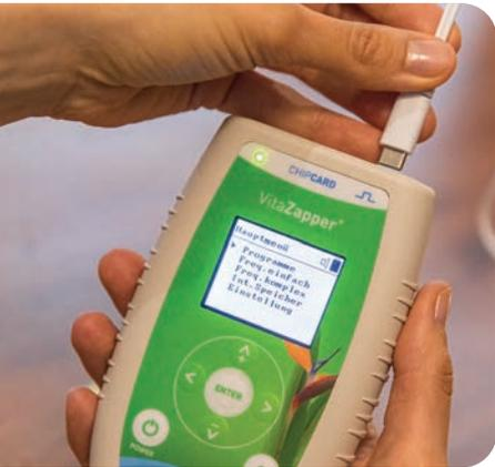
Stecken Sie den **USB C Stecker des Kabels** in die **Anschlussbuchse auf der Oberseite** des Gerätes. Das Kabel kann vor oder nach dem Einschalten angeschlossen werden. Bitte beachten Sie die Sicherheitshinweise zur Elektrodenanbringung auf S. 16 ff.
